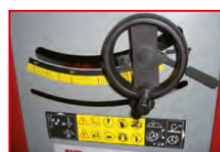
Sägeblatt Höhenverstellung / saw blade height adjustment
