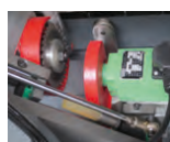
Kantenendanschnitt end cutting
