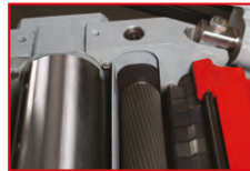
spiralverzähnte Einzugswalze spiral-toothed infeed roller
