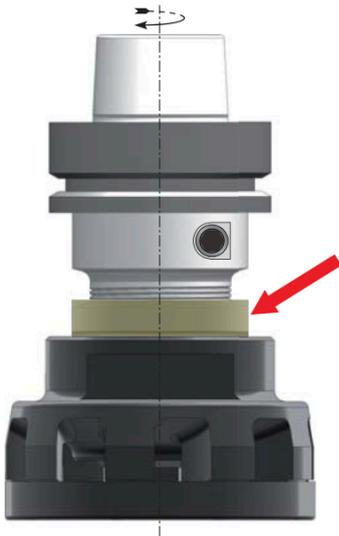
Svitare la ghiera di bloccaggio per permettere la regolazione della turbina.
