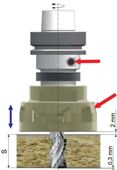
Montare la punta sul mandrino e bloccarla tramite il grano di pressurizzazione.
