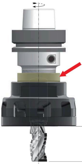
Avvitare la ghiera di bloccaggio per bloccare la turbina.
