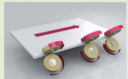
Schritt 3: Finishaggregat mit Poliereinheit
