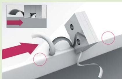
Schritt 2: Doppel-Ziehklänge für perfekte Geometrien
