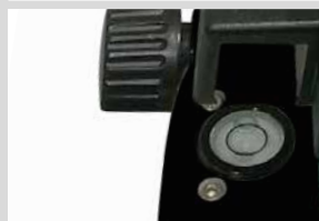
Handig verstelbare klapspiegel voor het eenvoudige uitlijnen door middel van een dooswaterpas
