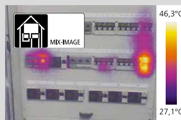
MIX-beeld: overlay infrarood/ digitaal beeld met isothermfunctie
