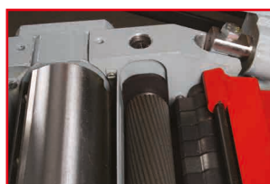
spiralverzahnte Einzugswalze spiral-toothed infeed roller
