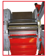
Präzisionslagerung precision-bedded cutterblock
