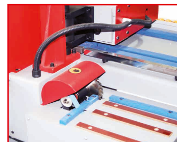
Kantenendabschnitt als externe Einheit ausgeführt external end cutting unit
