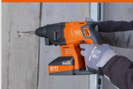
Hamerboren in beton tot 20 mm.
