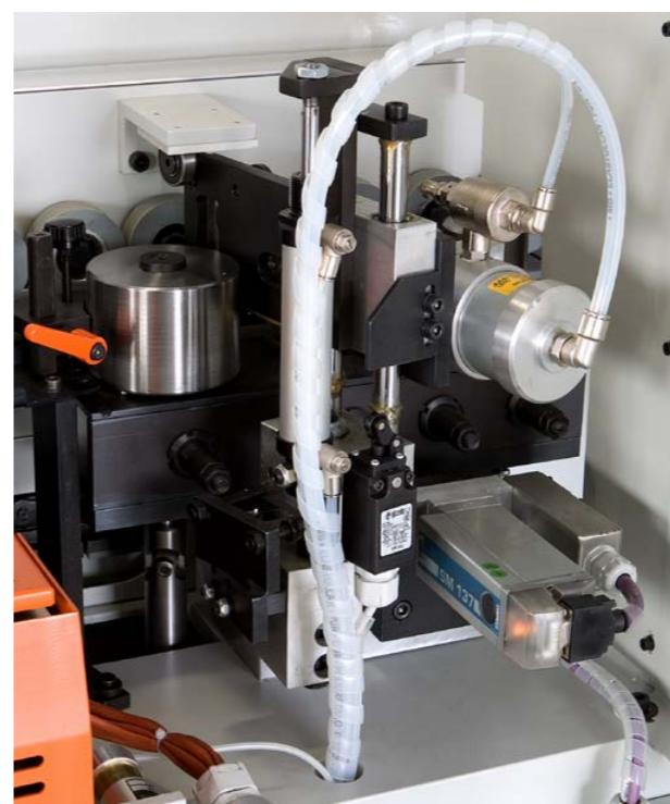
Gruppo traversa con sistema di posizionamento DIGIT O1
