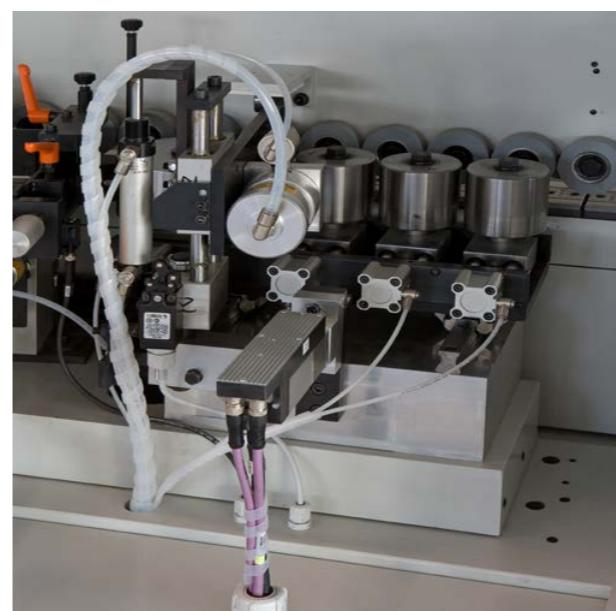
Gruppo traversa con sistema di posizionamento DIGIT O1 (8-15mm)
