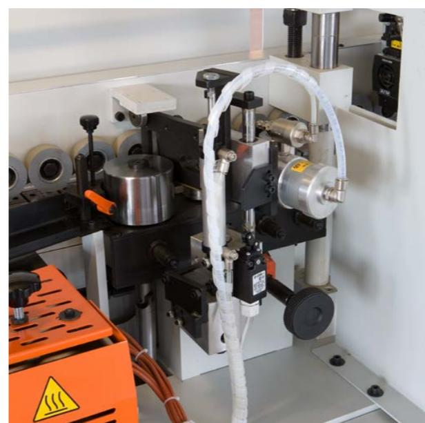
Gruppo traversa con sistema di posizionamento manuale
