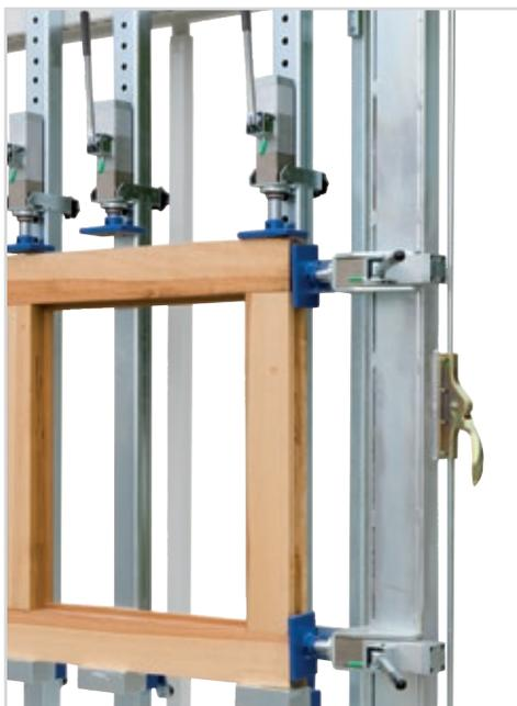
Mit dem neuen, zentral betätigten Seitendruckbalken ist die Bedienung noch einfacher geworden.
