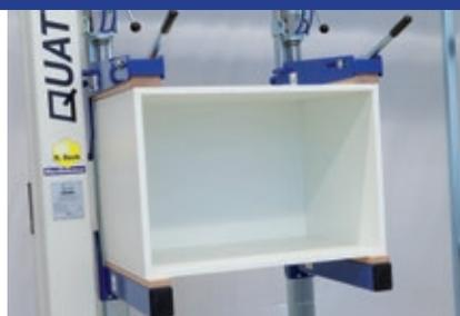
Die Herstellung eines geschlossenen Möbelements wird mit der QUATTRA-Korpuspresseinrichtung zum Kinderspiel. Gegenlager und Presselement werden einfach auf den passenden Vertikaldruckbalken befestigt und in die richtige Position gebracht. Zur rechtwinkligen Pressung werden die Presselemente durch Exzenterhebel unterstützt.
