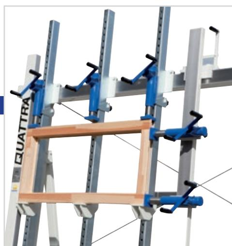
Die Rahmenpresseinrichtung verfügt über ein durchgehendes linkes Widerlager und einen Schiebeschlitzen, der im 50 mm Raster mit 2 Winkelgetrieben arretiert werden kann.
