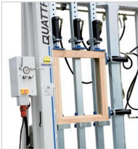
Mit dem neuen, zentral betätigten Seitendruckbalken ist die Bedienung noch einfacher geworden.
