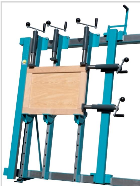
Die QUATTRA LC verfügt über 3 wälzgelagerte Druckbalken mit Trapezspindelgetriebe. Die Getriebe erreichen eine maximale Presskraft von 20.000 N und einen Hub von 150 mm.
