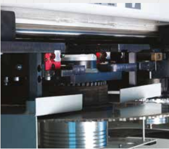
Salita lame indipendenti su guide con pattini a rullo di sfere. Avanzamento del carro lame con sistema pignone e cremagliera e scorrimento del carro su guide cilindriche Independent rising of blades on guides with recirculating ball. Saw carriage movement with rack and pinion system and carriage sliding on cylindrical guides. Subidas de las sierras independientes sobre guías con patines de bolas. Avance del carro de las sierras con sistema de cremallera y piñón y deslizamiento sobre guías cilíndricas Unabhängiger Sägeblattantrieb auf Führungen mit Kugelschnecken-Gleithocken. Sägewagenantrieb mit Ritzel und Zahnstangensystem und Gleiten des Sägewagens auf zylindrischen Führungen Subidas de las sierras con guías con patines de bolas. Avance del carro de las sierras con sistema de parrilla y cremallera y desplazamiento del chariot sobre guías cilíndricas a bolas
