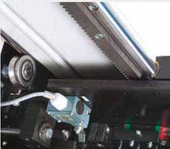
Salita lame indipendenti su guide con pattini a rullo di sfere. Avanzamento del carro lame con sistema pignone e cremagliera e scorrimento del carro su guide cilindriche Independent rising of blades on guides with recirculating ball. Saw carriage movement with rack and pinion system and carriage sliding on cylindrical guides. Subidas de las sierras independientes sobre guías con patines de bolas. Avance del carro de las sierras con sistema de cremallera y piñón y deslizamiento sobre guías cilíndricas Unabhängiger Sägeblattantrieb auf Führungen mit Kugelschnecken-Gleithocken. Sägewagenantrieb mit Ritzel und Zahnstangensystem und Gleiten des Sägewagens auf zylindrischen Führungen Subidas de las sierras con guías con patines de bolas. Avance del carro de las sierras con sistema de parrilla y cremallera y desplazamiento del chariot sobre guías cilíndricas a bolas
