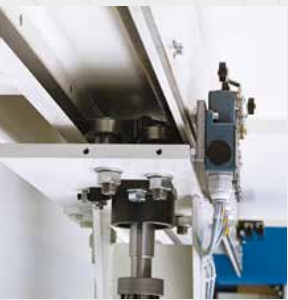
Movimentazione con pignoni e cremagliere e posizionamento tramite sensore e banda magnetica Movement and positioning by racks and pinions with sensor and magnetic strip Desplazamiento y posicionamiento con cremalleras y pñones de movimiento a través de sensor y banda magnética Bewegung mit Ritzel und Zahnstangen und Positionierung durch Sensor und Magnetband Mouvement et positionnement àvec pignon et crémaillères au moyen du capteur et bande magnétique
