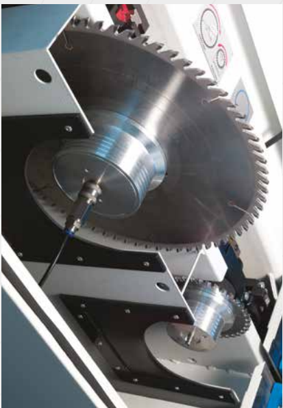
Carro-lame con cambio pneumatico degli utensili Saw carriage with pneumatic saw blades change Carro porta-hojas con cambio neumático de las sierras Sägewagen mit einfräthem pneumatischem Sägeblattwechsel Chariot porte-lames avec changement pneumatique des lames
