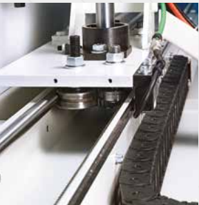
Movimentazione con pignoni e cremagliere e posizionamento tramite sensore e banda magnetica Movement and positioning by racks and pinions with sensor and magnetic strip Desplazamiento y posicionamiento con cremalleras y pñones de movimiento a través de sensor y banda magnética Bewegung mit Ritzel und Zahnstangen und Positionierung durch Sensor und Magnetband Mouvement et positionnement àvec pignon et crémaillères au moyen du capteur et bande magnétique
