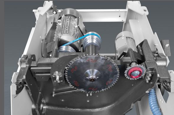
Zaagaggregate uit gietijzer voor hoge precisie en stabiliteit. Deze hangt in een frame met extra torsiebus voor nog meer stabiliteit.
