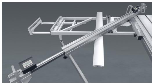
Grote oplegtafel met schuinstelbare aanslagbalk. Het indexsysteem met lengtecorrectie vergemakkelijkt het nauwkeurig zagen van hoeken en versteekken. De optionele digitale aflezing kan dankzij een uniek systeem over de volledige lengte van de stevige aanslagbalk gebruikt worden (0-3200 mm).
