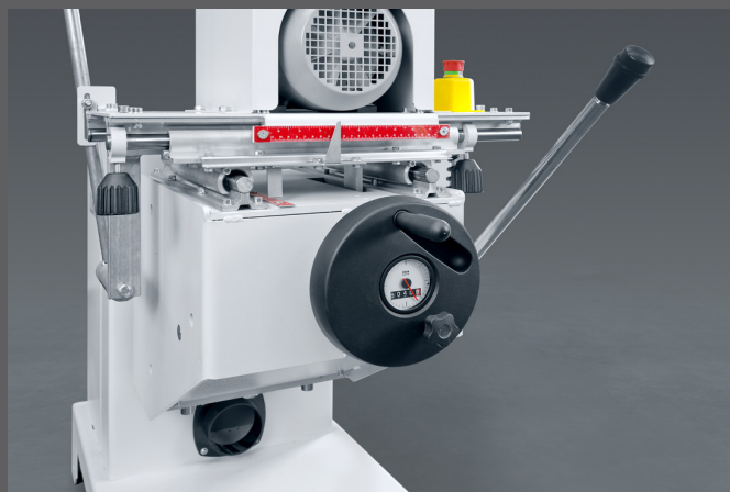
Handwiel voor de hoogteverstelling met een precisie tot 0,1 mm.
