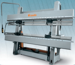
CARLINI - CILINDRO ORIZZONTALE - BLOCCAGGIO TROUPLY - HORIZONTAL CYLINDER - LOCKING
