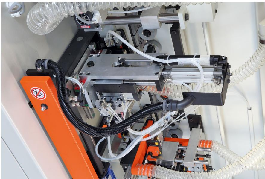
● Gruppo arrotondatore A-PR 02 a 1 motore HF a 12.000 g/1' per la lavorazione degli spigoli.
